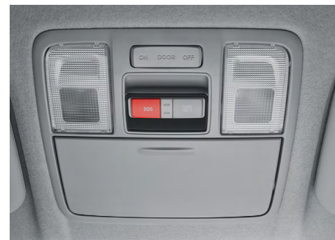
Система «Эра-Глонасс» / Помощь на дороге 24/7 Устанавливает оперативную связь с экстренными службами.
